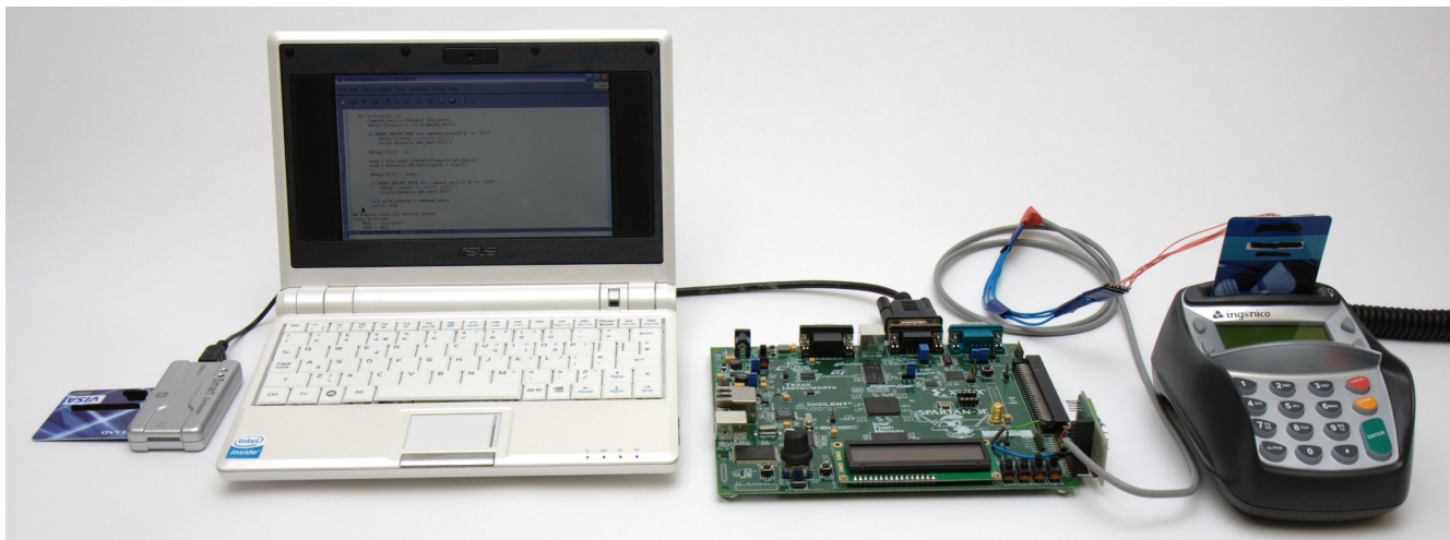
Figura 3: Setup sperimentale dell'attacco MITM dell'Università di Cambridge [6].
